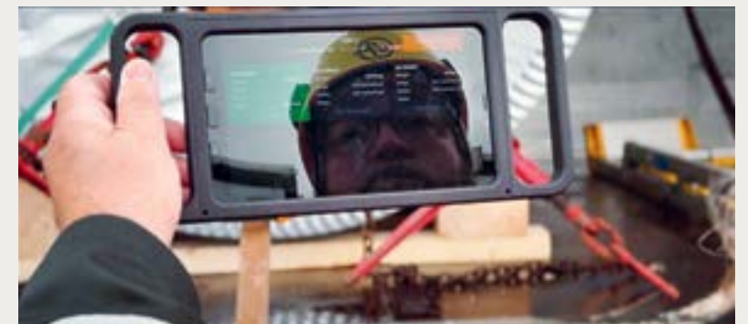
2. Sidottu kuorma kuvataan ja AI-kamerasovellus kertoo onko kuorma sidottu oikein.
